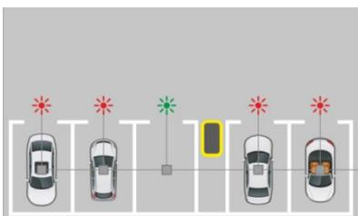
Датчики **S400L** и **S400L-01** не имеют встроенной световой индикации состояния парковочного места и предполагают использование выносных индикаторов (ВИ).
